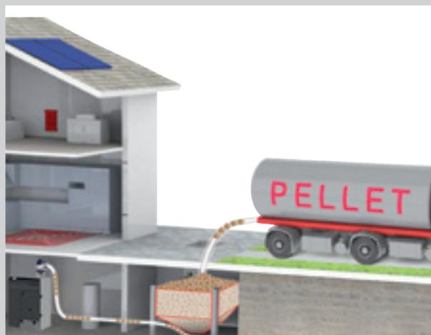
Esempio di approvvigionamento pellet tramite autobotte
