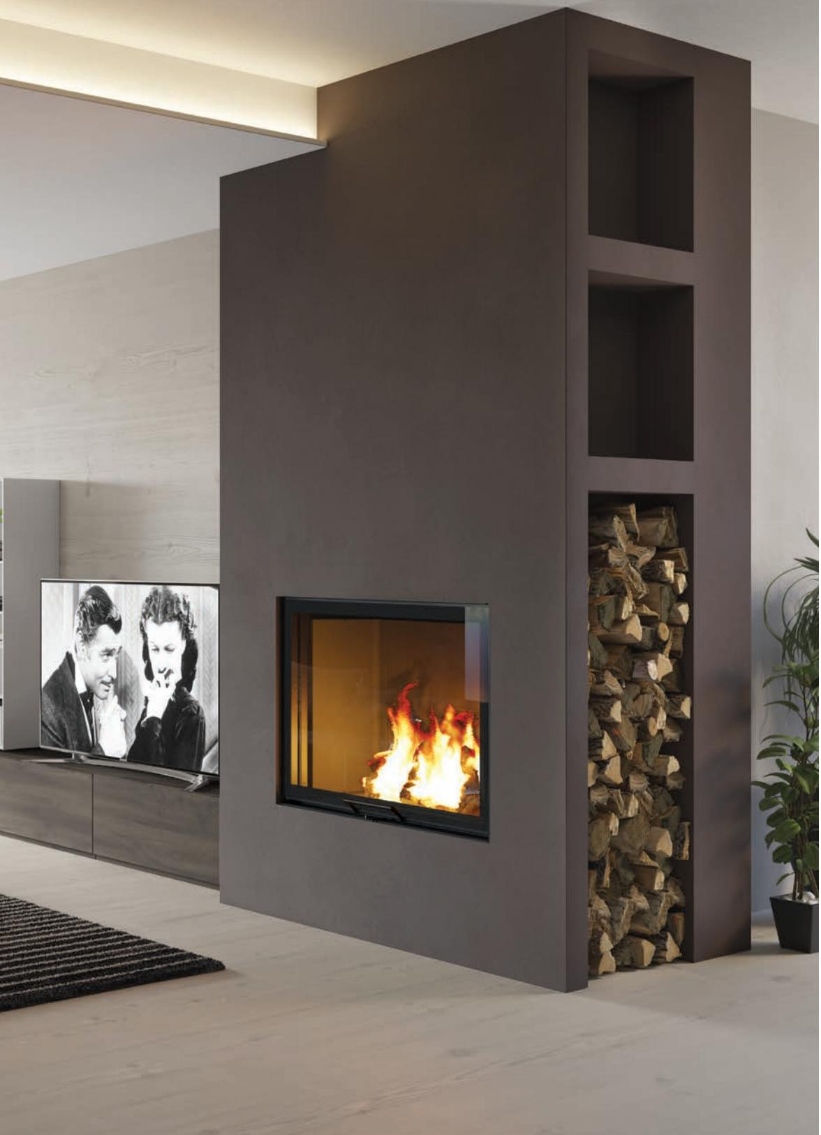
**FR** **Foyer à bois canalisable** avec vitre sur trois côtés prismatique. Foyer en fonte. Air chaud canalisable jusqu'à 4 pièces adjacentes (kit en option). Ouverture de la porte coulissante. Post-combustion. Panneau synoptique frontal pour version V. Disponible à Convection naturelle (N) ou ventilation forcée (V).
