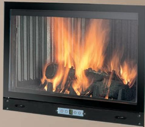
FR **Foyer à bois canalisable** avec vitre d'angle droit ou gauche. Foyer en fonte. Air chaud canalisable jusqu'à 4 pièces adjacentes (kit en option). Ouverture de la porte coulissante. Post-combustion. Panneau synoptique frontal pour version V. Disponible avec convection naturelle (N) ou ventilation forcée (V).
