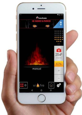
Die Edilkamin APPs ermöglichen, mit allen **Grundfunktionen** von einem Pelletprodukt mit der Benutzung eines **Smartphones oder Tablet**, zuhause oder außer Haus, von überall, dafür reicht eine verfügbare Datenverbindung.
